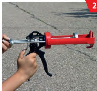
2 Kartusche in die für die Kartuschengröße passende Auspresspistole\* einspannen.
