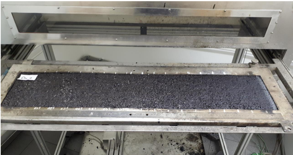
Bild 8: Probekörper 3 nach der Prüfung
