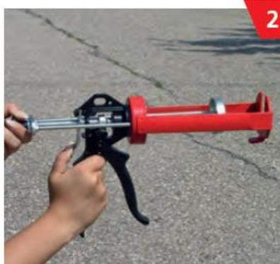
Kartusche in die für die Kartuschengröße passende Auspresspistole einspannen.
